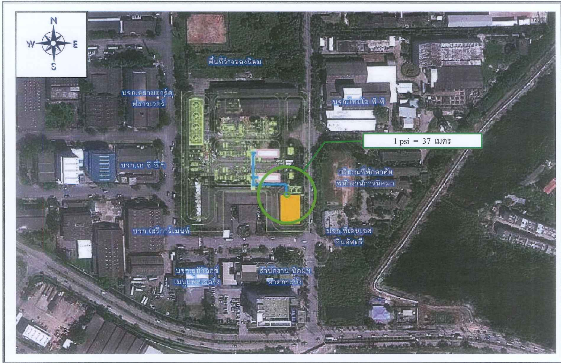
รูปที่ 7 ผลกระทบจากแรงดันกรณีเกิดการระเบิด บริเวณจุดเชื่อมต่อระหว่างสถานีควบคุมความดันกับแนวท่อส่งก๊าซของโครงการ จากการรั่วไหล กรณีที่มีโอกาสเกิดขึ้นมากที่สุด พิจารณานาตรอยรั่วเท่ากับ 1 นิ้ว
